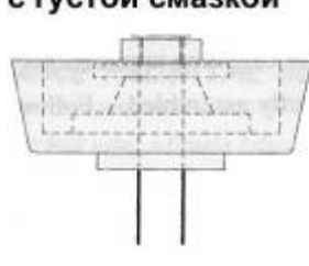
Рисунок Y (ii) Положение плунжера в сборе для использования с густой смазкой
