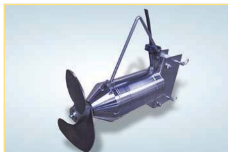
Конструкция из нержавеющей стали Восьмиполюсные двигатели мощностью от 1,5 до 2,5 кВт с планетарным редуктором Лопастей Ø 300-440 мм. От 700 до 750 об./мин.
