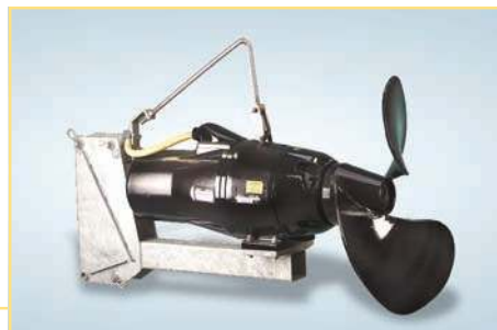
Конструкция из чугуна Четырехполюсные двигатели мощностью от 1,1 до 15,0 кВт с планетарным редуктором Лопастей Ø 540-850 мм От 220 до 350 об./мин.
