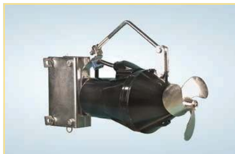
Конструкция из чугуна Шестиполюсные двигатели мощностью от 1,1 до 15,0 кВт с прямой передачей Лопастей Ø 280-425 мм 1000 об./мин.
