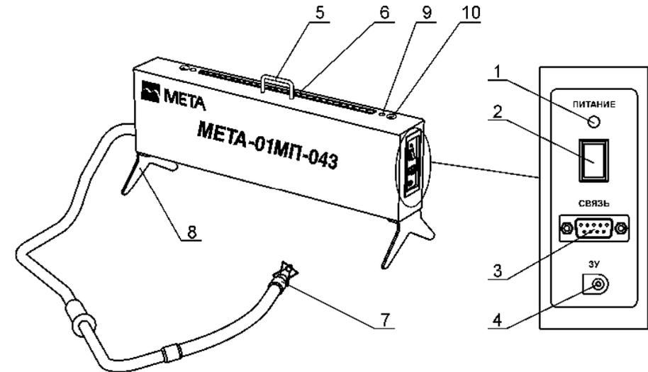
1 - Индикатор питания; 2 – Выключатель напряжения питания; 3 – Разъем для подключения кабеля связи; 4 – Разъем для подключения зарядного устройства; 5 – Ручка; 6- Канал выхода пробы через оптический датчик; 7 – Пробозаборное устройство; 8 – Ножки; 9-Отверстие для продувки оптических элементов; 10-Шторки для очистки оптических элементов
