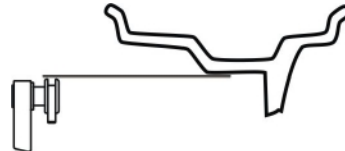
Рисунок 6.14 – Прямой ввод диаметра при статической балансировке при помощи выноски
