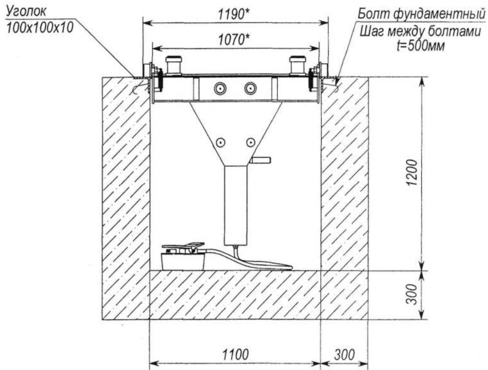
Рис. 2. Монтажный чертеж
