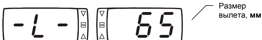
Рисунок 2.21 – Показания индикаторов во время пользования электронной линейкой для измерения вылета (измеритель диаметра выключен)
