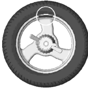
Рисунок 6.3 – Груз установлен в положение «12 часов»
