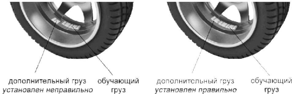
Рисунок 7.2 – Положение дополнительного груза
