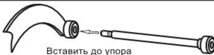
Рисунок 7.6 – Использование удлинителя линейки
